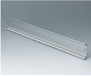
C7117077 Barrette normalisée, type TH 35 Acier 220x35x7,5mm
