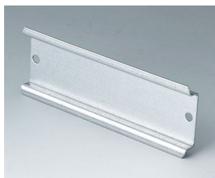
C7111077 Barrette normalisée, type TH 35 Acier 104x35x7,5mm
