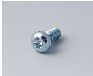
A0305031 Vis autotaraudeuses 2,5 x 6 mm (PZ1)
