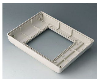
B4044757 Partie inférieure M surélevée, version I ABS (UL 94 HB) gris blanc RAL 9002 225x165x35,5mm IP 54 opt.
