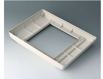
B4046767 Partie inférieure L surélevée, version II ABS (UL 94 HB) gris blanc RAL 9002 275x195x36,5mm IP 54 opt.
