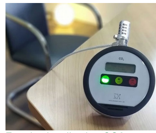
Feu de signalisation CO2
