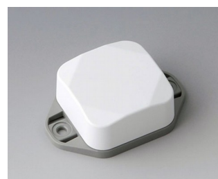
B1802226 MINI-DATA-BOX SF40, haute avec bride ASA+PC (UL 94 V-0) blanc signalisation RAL 9016 40x40x20mm IP 65 opt., IP 40
