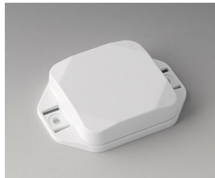
B1804127 MINI-DATA-BOX SF50, plate avec bride ASA+PC (UL 94 V-0) blanc signalisation RAL 9016 50x50x15mm IP 65 opt., IP 40
