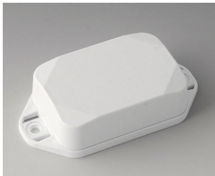
B1822227 MINI-DATA-BOX EF40, haute avec bride ASA+PC (UL 94 V-0) blanc signalisation RAL 9016 60x40x20mm IP 65 opt., IP 40
