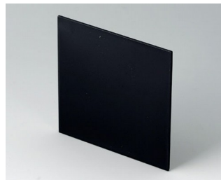
B6134221 Plaque avant PPO (UL 94 V-0) noir RAL 9005 90,7x90,7x2mm
