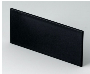
B6121221 Plaque avant PPO (UL 94 V-0) noir RAL 9005 67,8x31,7x2mm
