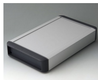
B3407032 SMART-TERMINAL 240 Aluminium AlMgSi 0,5 anodisé mat 282x170x50mm IP 54
