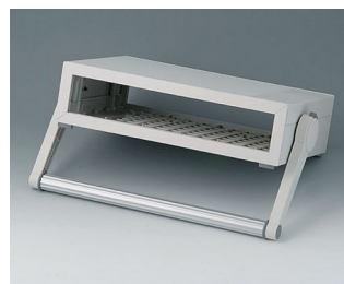
B2211117 MEDITEC D 160, avec poignée étrier ABS (UL 94 HB) gris blanc RAL 9002 290x200x74mm IP 40
