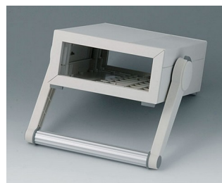
B2213117 MEDITEC E 160, avec poignée étrier ABS (UL 94 HB) gris blanc RAL 9002 160x200x74mm IP 40
